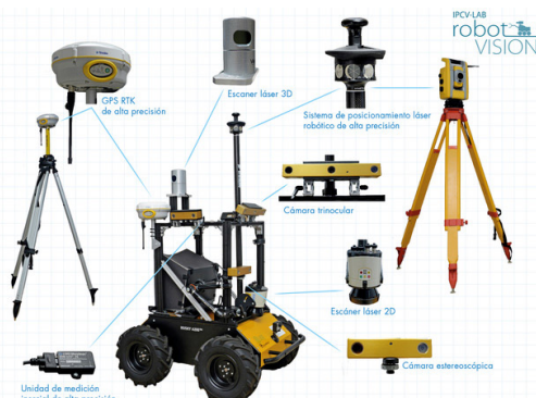
IPCV-LAB: Robot Husky A200 para validación de tecnologías en visión por computador.
